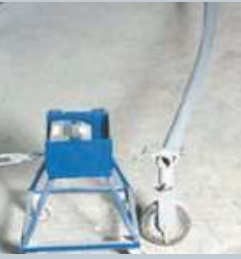
Eğilme mukavemet testi. Bending strength test.
